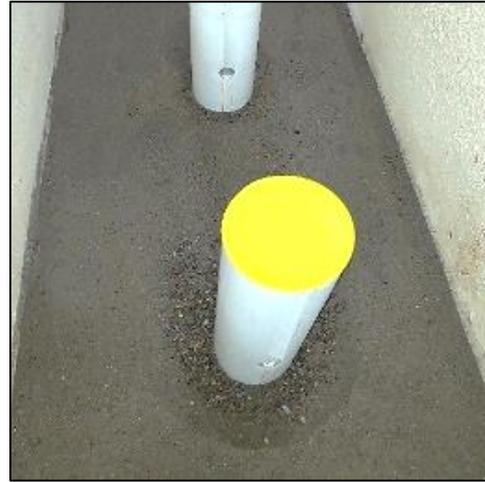
الشكل (5) يوضح تجمع الحبيبات الاخشن للتربة بعد مرور زمن الاستقرار
